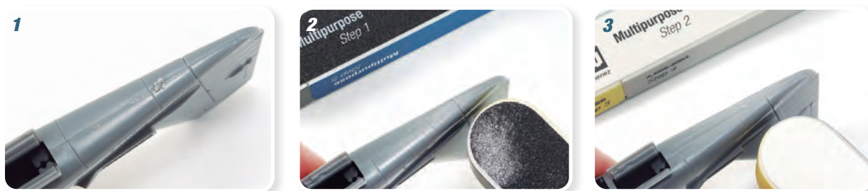
1,2. Remove large defects and unevenness with the 150 grit Step 1. / Elimina los grandes defectos y desniveles con el Step 1 de grano 150. 3. Evens out and levels surfaces with Step 2, 240 grit. / Iguala y nivela las superficies con el Step 2 de grano 240. 4. Smooth surfaces with Step 3 and 4 in 320 and 600 grit. 5. Polishes surfaces with Step 5 and 6 in 1200 and 2000 grit. / Pule las superficies con los Step 5 y 6 de granos 1200 y 2000.
