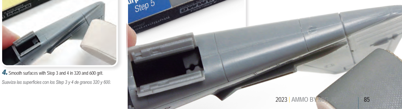
1,2. Remove large defects and unevenness with the 150 grit Step 1. / Elimina los grandes defectos y desniveles con el Step 1 de grano 150. 3. Evens out and levels surfaces with Step 2, 240 grit. / Iguala y nivela las superficies con el Step 2 de grano 240. 4. Smooth surfaces with Step 3 and 4 in 320 and 600 grit. 5. Polishes surfaces with Step 5 and 6 in 1200 and 2000 grit. / Pule las superficies con los Step 5 y 6 de granos 1200 y 2000.
